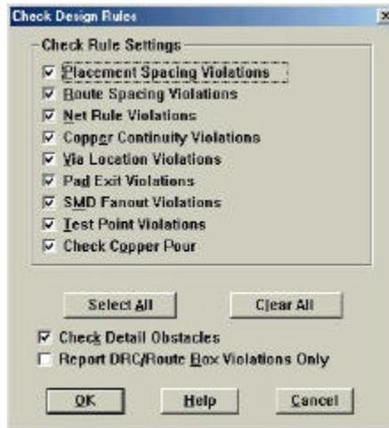
Figura 4.29 Ventana de las Reglas de Diseño
